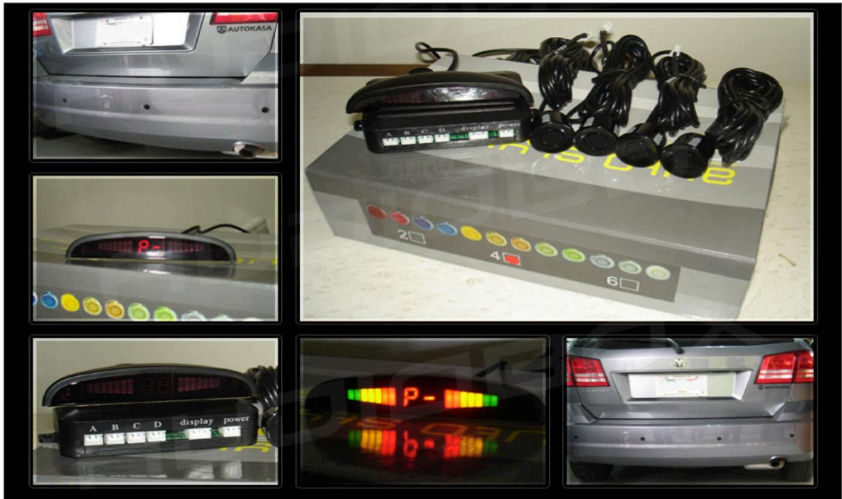
Los sensores de reversa son útiles para detectar cualquier obstáculo al estacionarse, al poner la marcha en reversa evitando de esta manera accidentes. Contamos con sistemas también de 6 puntos que permiten detectar la distancia al frente del vehículo. Los sistemas constan de:
