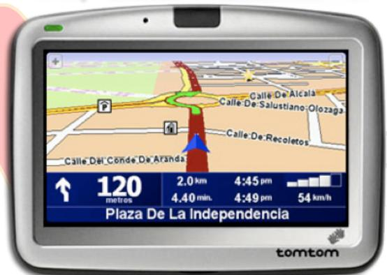
El GPS ( Global Positioning System: sistema de posicionamiento global) o NAVSTAR-GPS. Es un sistema global de navegación por satélite (GNSS) que permite determinar en todo el mundo la posición de un objeto, una persona o un vehículo con una precisión hasta de centímetros (si se utiliza GPS diferencial), aunque lo habitual son unos pocos metros de precisión. El sistema fue desarrollado, instalado y actualmente operado por el Departamento de Defensa de los Estados Unidos.
